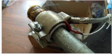
Das Heizband wird von einem Temperatursensor überwacht
