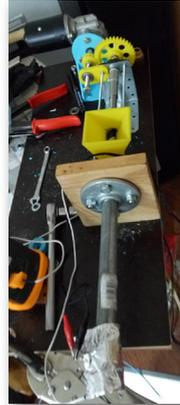
Überblick über den ersten Aufbau, hier schon mit dem ersten Getriebe für die Drehmoment-Steigerung.
